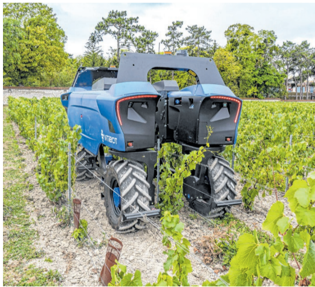
Bakus, tractor vitícola autónomo para viñedos.
